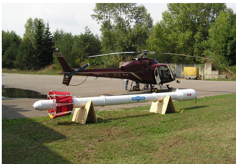
Obr. 3.1-1 Elektromagnetický systém a zavěšená gondola na zemi
