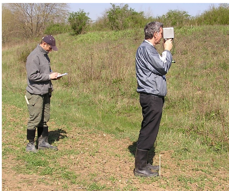
Obr. 3.1-3 Přístroj EM 16 (metoda VDV) při měření v terénu
