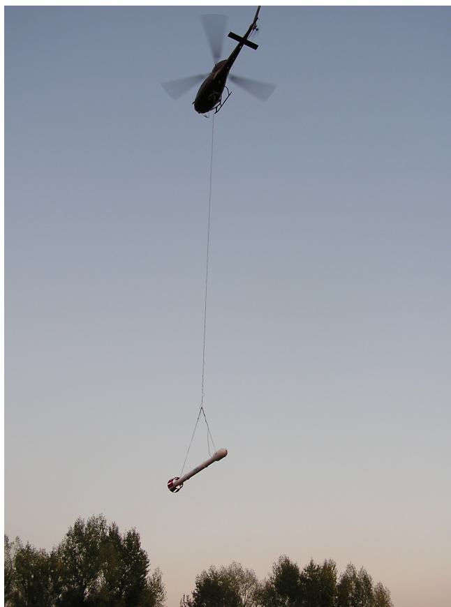
Obr. 3.1-2 Elektromagnetický systém a zavěšená gondola za letu
